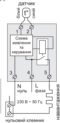
Схема 1. Спрощена внутрішня схема і схема підключення
