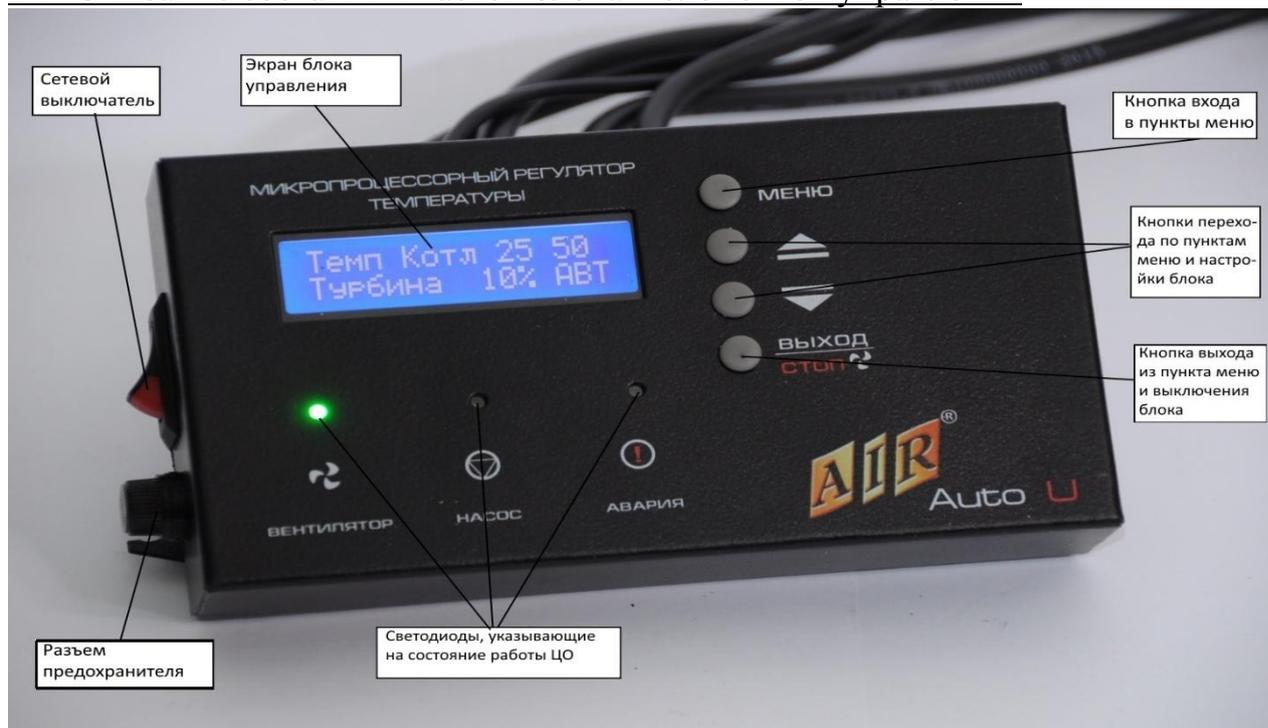
**Сетевой выключатель** – предназначен для включения/выключения блока AIR AUTO +/- AIR AUTO U+.
