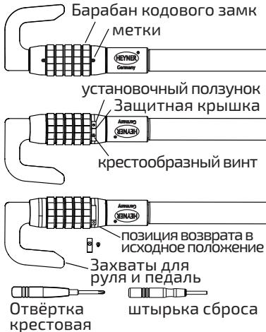
Противоугонное устройство на руль и педаль с устанавливаемым кодовым замком „PedalBlock PRO“
