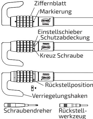
Einstellbare Lenkraddiebstahlsicherung mit Zahlschloss HEYNER® „WheelBlock PRO“
