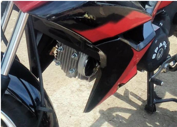
Нижние боковые обтекатели обеспечивают оптимальный воздушный поток для охлаждения двигателя.
