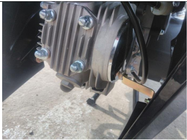
Рубашка цилиндра с продольными ребрами охлаждения
