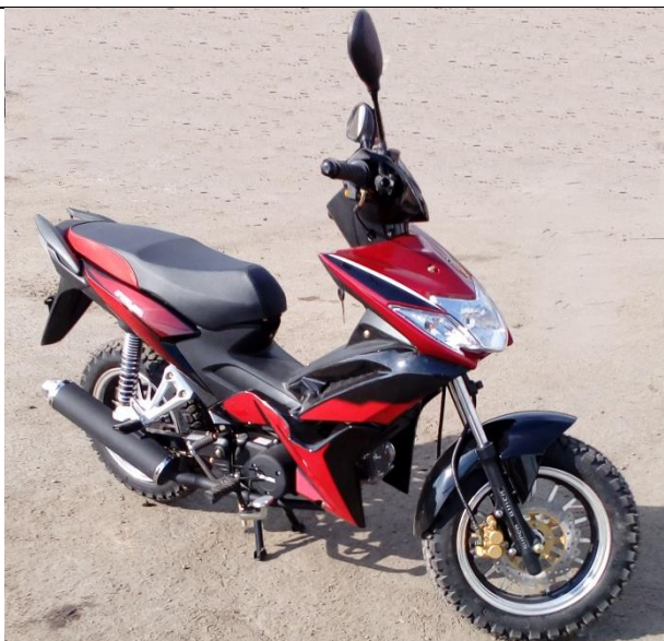
Компоновка с заниженной рамой. Водителю удобно садиться и вставать.
