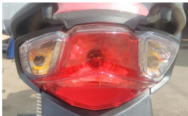
Большой задний комбинированный фонарь с двухнитевой лампой. Встроенные указатели поворотов. Задний катафот-отражатель для повышения безопасности. Вся оптика сертифицирована по евростандарту.
