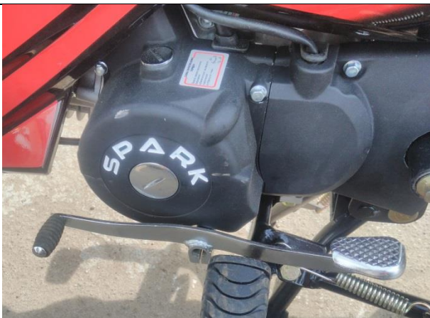
Круговая коробка передач 0-1-2-3-4-0-. Автоматическая муфта сцепления. Удобный рычаг переключения КПП с «пяткой».
