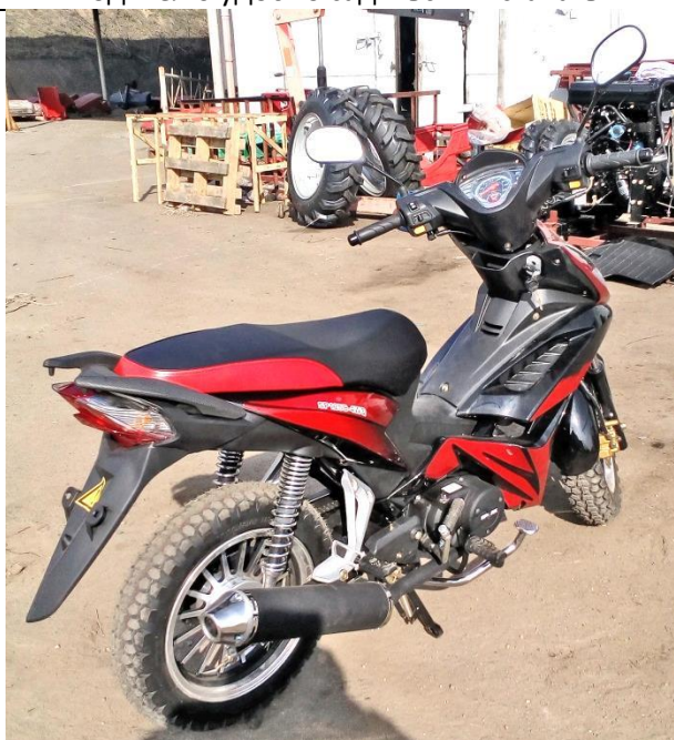
Объемные профилированные боковые обтекатели, как у круизного мотоцикла, хорошо защищают ноги водителя от грязи из-под переднего колеса.
