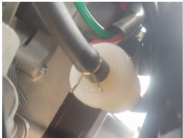
Дополнительный сменный топливный фильтр.
