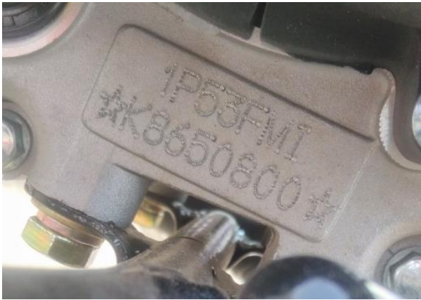
Двигатель 1R53FMI, 124 куб.см., 6.2 кВт (8.4 л.с.)
