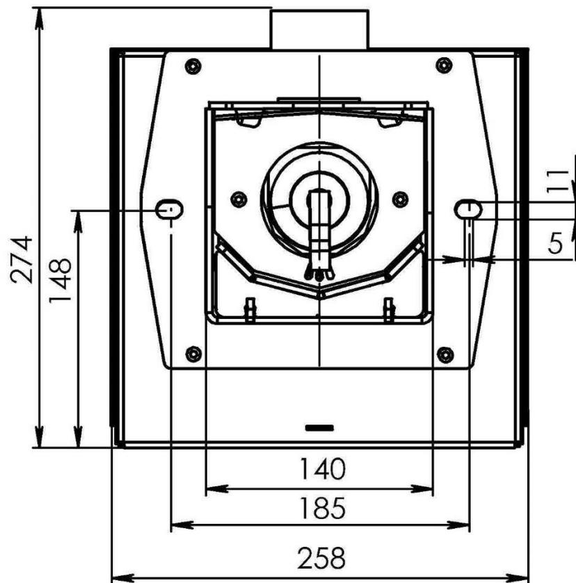
Рисунок 3 - Габаритные размеры горелки
