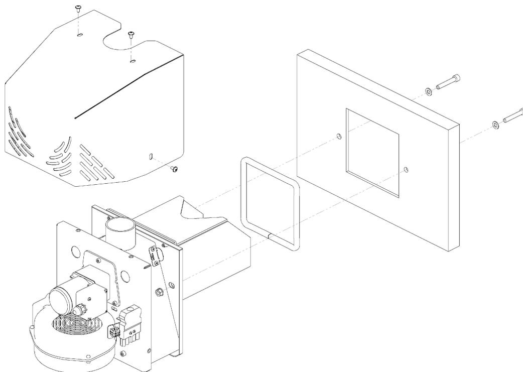
Рисунок 7 – установка горелки Air Pellet 36
