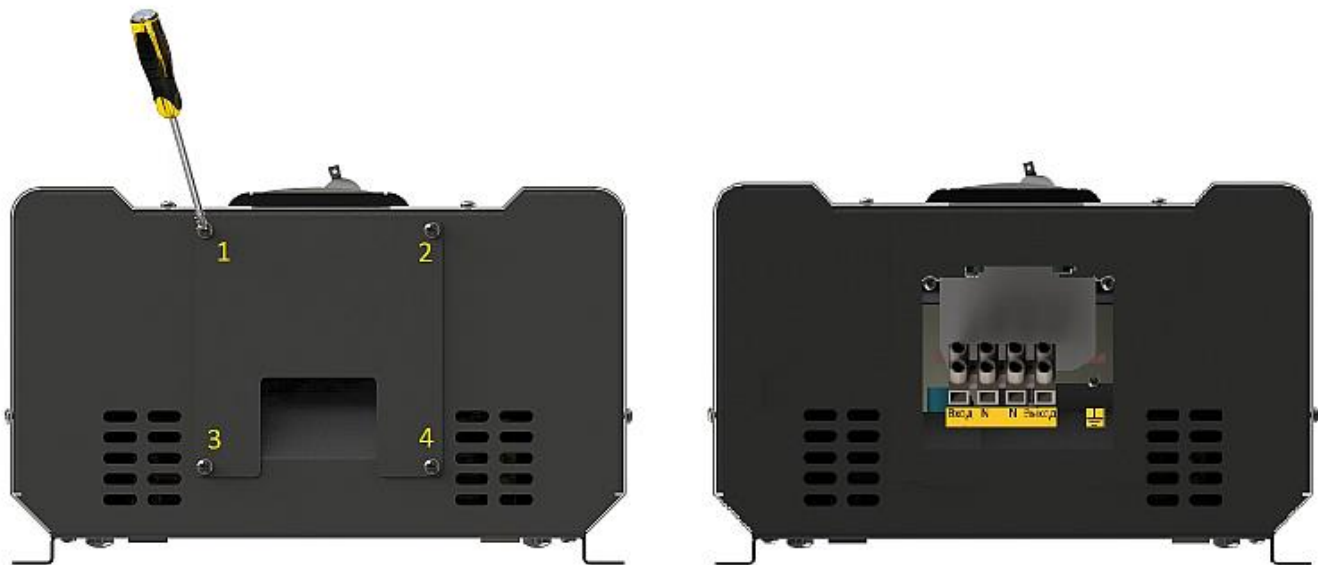
Рисунок 8. Схема снятия защитной крышки снизу корпуса стабилизатора
