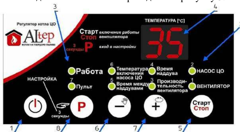
Рисунок 3 – Зовнішній вигляд передньої панелі контролера
