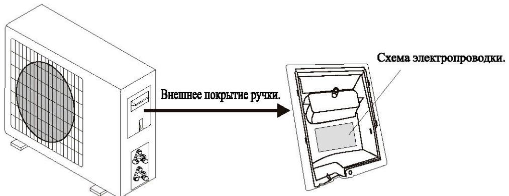
Обратите внимание: для некоторых моделей провода подключены к плате управления внутреннего блока производителем без клеммной колодки.
