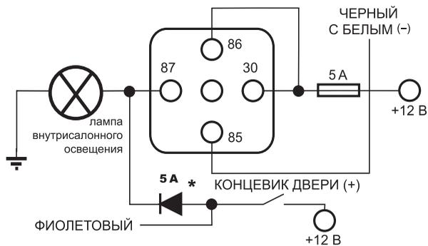
\* Дополнительный развязывающий диод (устанавливается при необходимости).
