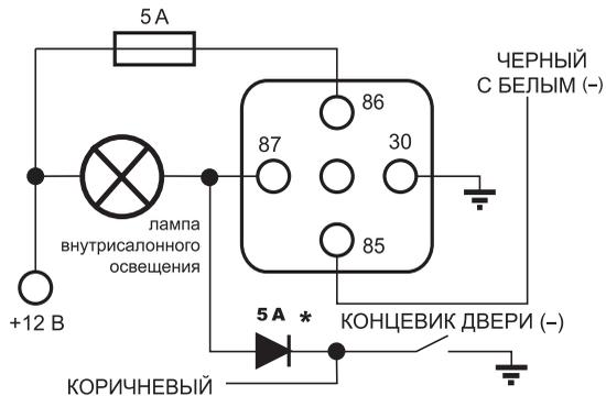
\* Дополнительный развязывающий диод (устанавливается при необходимости).
