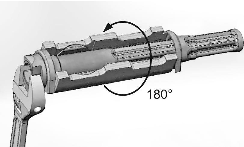
**4b.** Повернувши, зніміть її з газової трубки, опустивши донизу.
