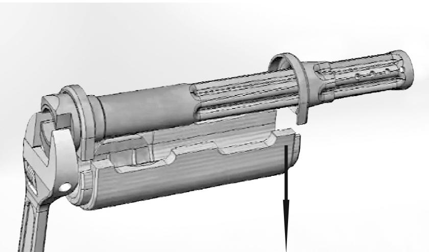
5. Встановіть тягу перенесення вогню на карабін/автомат таким чином, щоб скруглена її сторона одягалася на штатний спусковий гачок, а гострий її кінець вставте в отвір під шомпол, в нижній частині кільця цев'я.
