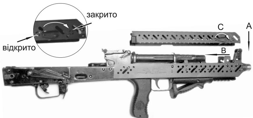
**9.** Встановіть приклад-потиличник, завівши його над верхніми заклепками ствольної коробки, допоки його нижня частина корпусу не доторкнеться до тяги управління вогнем. Після цього поверніть приклад-потиличник під кутом 45 градусів до зброї і заведіть корпус приклада за тягу, потім вирівняйте приклад паралельно ствольній коробці.
