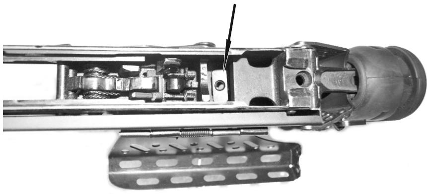
**12.** Утримуючи гайку кріплення пістолетної рукоятки, зафіксуйте приклад гвинтом.
