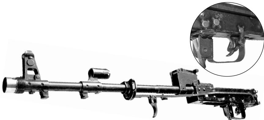
6. Встановіть цев'є в ствольну коробку з боку ствола під прицільною колодкою. Переконайтесь, що цев'є щільно встановлено у ствольну коробку і між ними не залишилось зазорів. Зафіксуйте цев'є кільцем і закройте прaporець на кільці цев'я.
