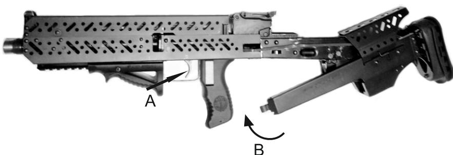
**10.** Одягніть приклад до упору в бік ствола. Зчепіть замок прикладу з прорізом кришки цев'я.
