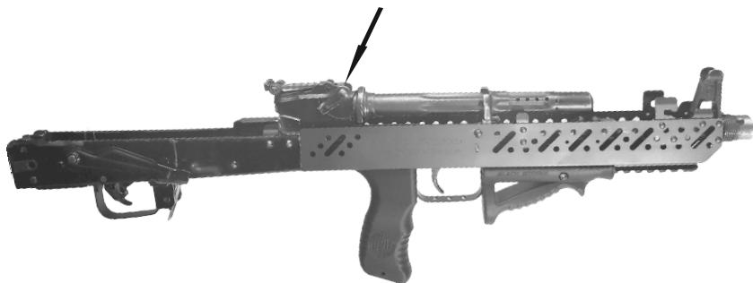
**8.** Візьміть кришку цев'я. Встановіть прапорець фіксатора в положення назад (відкрито). Кришку на цев'є встановіть так, щоб вона прилягала до площини цев'я по всій довжині. Закріпіть кришку на скобі фіксатора рухом у бік прицільної коробки до упору. Зафіксуйте кришку поворотом прапорця з а г о д и н и к о в о ю с т р і л к о ю .
