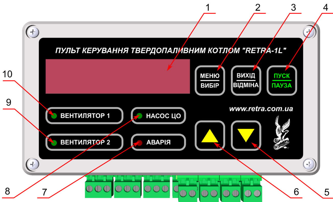
Рис. 1 Внешний вид пульта управления твердотопливным котлом RETRA - 1L
