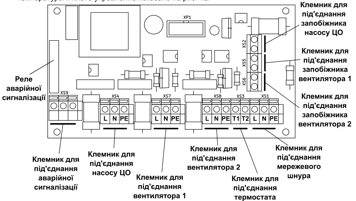
Рис. 10 Подсоединение кабелей к плате питания прибора
