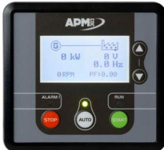
**Пульт APM303** — это многофункциональный прибор, обеспечивающий работу в ручном и в автоматическом режимах управления. Оснащённый в высокой степени интуитивным жидкокристаллическим дисплеем, он предоставляет качественные базовые возможности для упрощённого и надёжного управления Вашим электроагрегатом, включая возможность мониторинга его работы.
