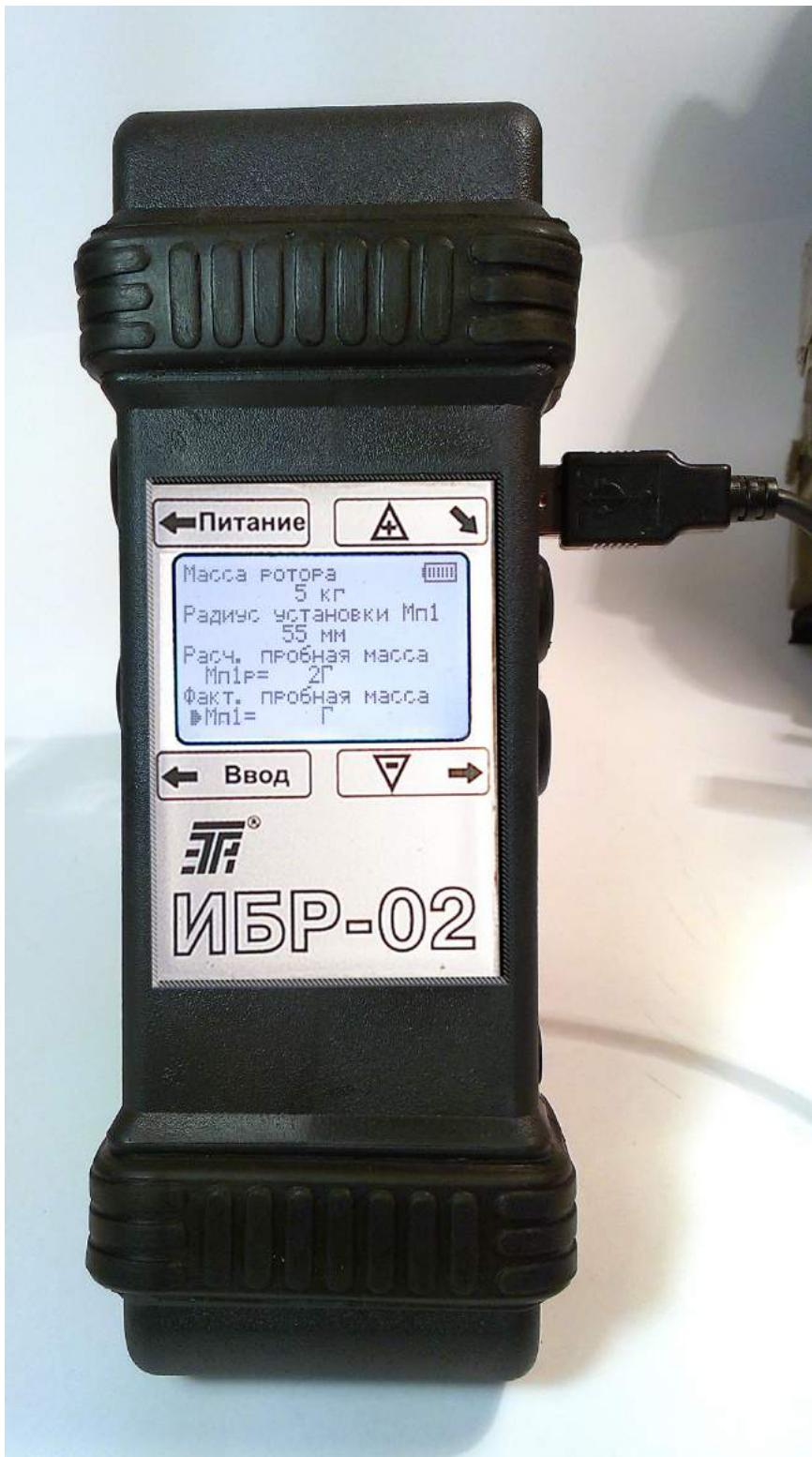
7. Підбираємо пробну масу (в нашому випадку найближча з набору пробних мас - 3 г) і встановлюємо її на шків на радіальній лінії, що проходить приблизно перпендикулярно вектору віброшвидкості V10. Вводимо її значення в пам'ять прилада.
