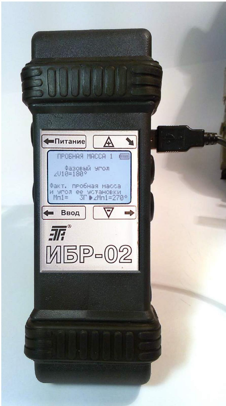
9. Запускаємо двигун і вимірюємо віброшвидкість на частоті обертання V11.
