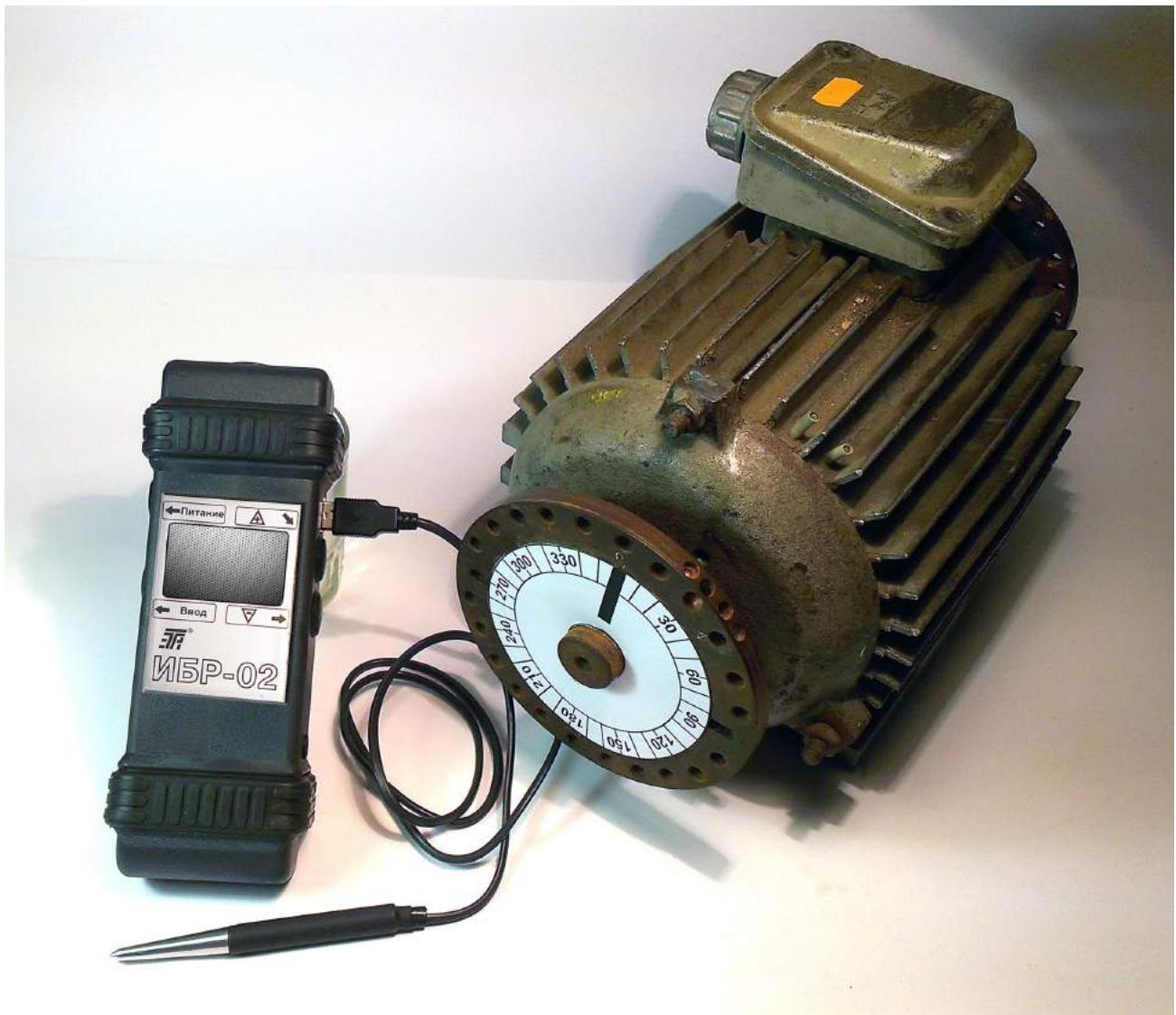
1. Запускаємо двигун і за допомогою вбудованого стробоскопа визначаємо частоту обертання ротора.
