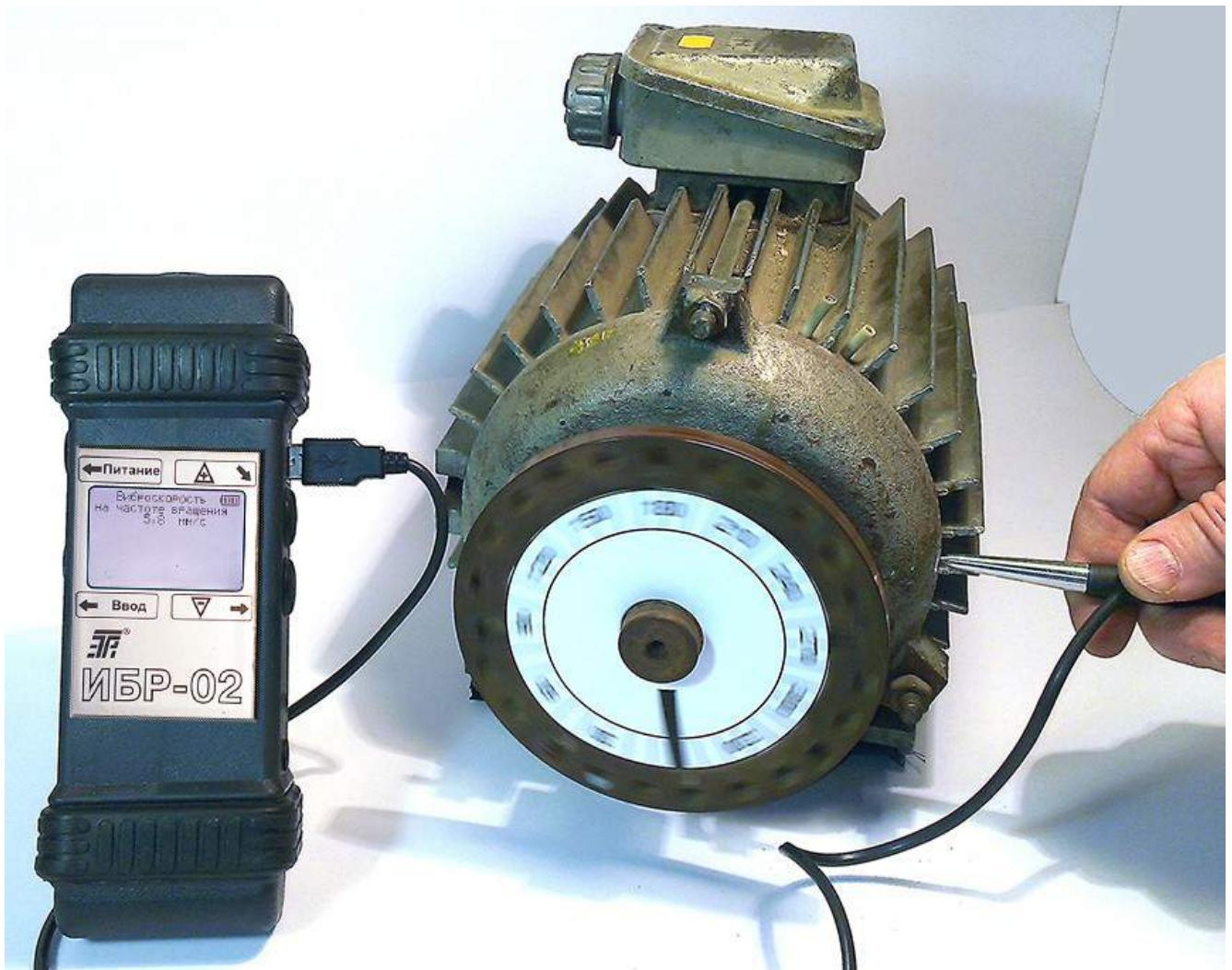
Найбільше значення віброшвидкості отримано в вертикальному напрямку, тому всі наступні вимірювання при балансуванні ротора будемо проводити в цьому напрямку.
