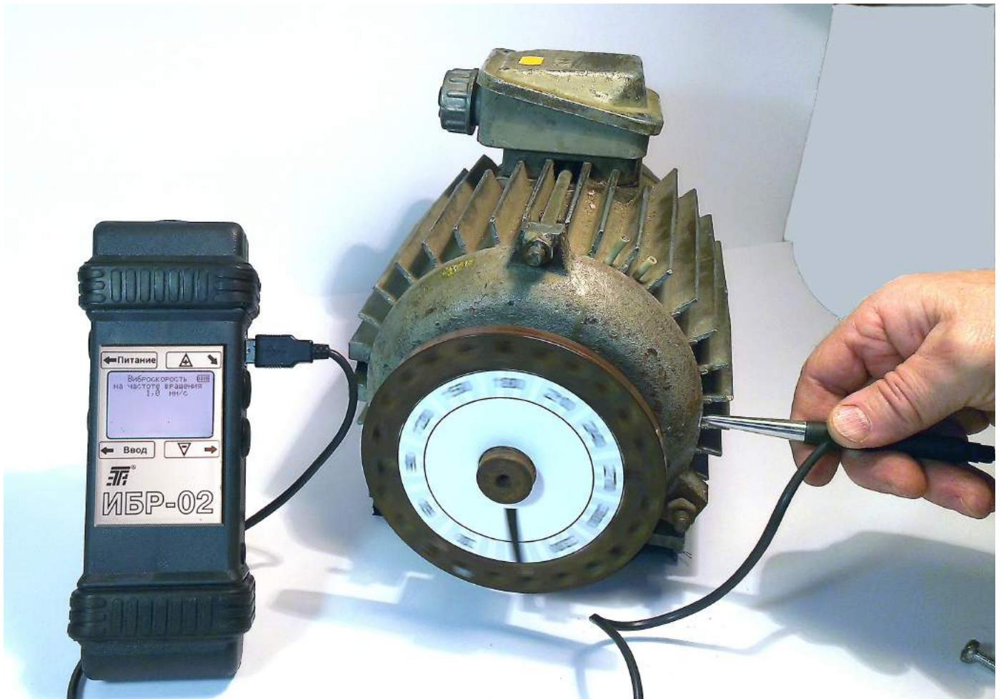
Результат балансування ротора вважаємо задовільним, так як отримані значення віброшвидостей не перевищують нормоване значення для даної машини.
