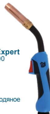
TBI 7W-CC Expert Серия Top 2000 100% (10 мин.) Mix: 500 A CO 2 : 550 A Ø 1.2-1.6 мм 2-х контурное водяное охлаждение
