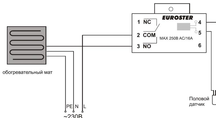
**ВНИМАНИЕ!** В случае пользования половым датчиком, следует подключить его к зажимам 4 и 5. При вынутых батарейках переставить джампер (перемычку) SENSOR в положение Ext.
