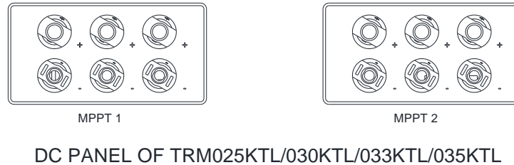
Панель постоянного тока TRM025KTL/030KTL/033KTL/035KTL
