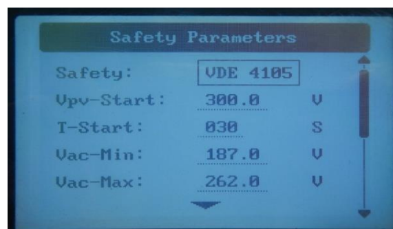
Рис. 5-8 Установка параметров безопасности
