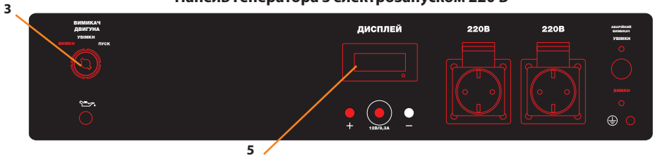
Панель генератора з електрозапуском 220 В та ATS
