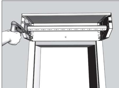
Просверлите отверстия в крышке короба и стене для крепления короба.
