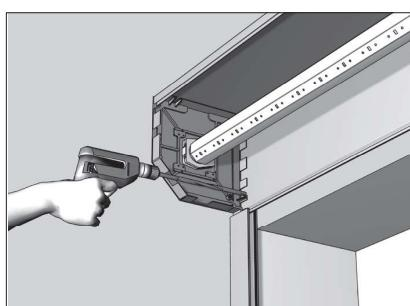
**Вариант монтажа роллеты с электроприводом.**
