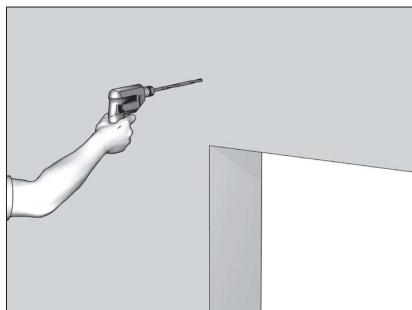
Рассверлите намеченные отверстия в стене для вывода элементов управления: для вывода кабеля электродвигателя, шнура, – отверстие  $\varnothing 12$  мм; для вывода ленты – отверстие  $\varnothing 16\text{--}18$  мм; для вывода кардана, корда – отверстие  $\varnothing 14\text{--}16$  мм; рассверлите отверстие  $\varnothing 20$  мм на необходимую глубину под цилиндрический выступ кардана.
