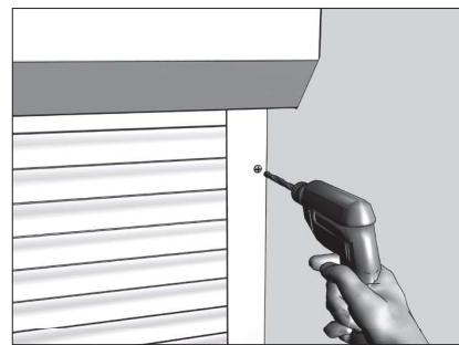
После окончания монтажа в целях повышения защитных свойств роллеты шляпки винтов и шурупов, крепящих направляющие и короб, должны рассверливаться.
