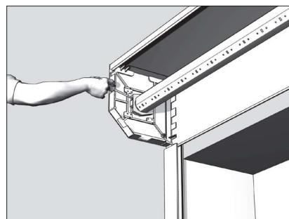
Настройка концевых выключателей осуществляется при помощи отвертки.
