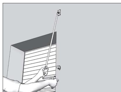
**Вариант монтажа роллете с карданным приводом.**
