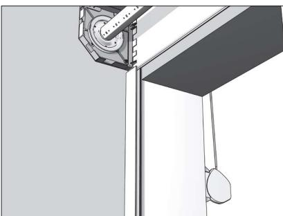
Общий вид роллете с ленточным приводом в сборе.
