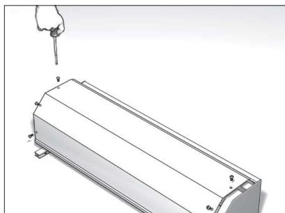
Снимите переднюю крышку короба: выкрутите саморезы с короба и потяните переднюю крышку на себя.
