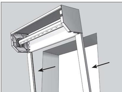
Снимите каркас роллеты с места монтажа.
