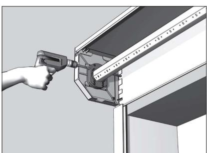
**Вариант монтажа роллеты с карданным приводом.**
