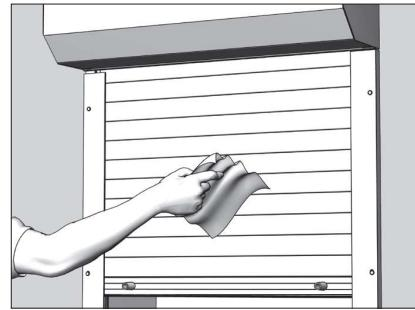
После завершения работ по монтажу роллет и отделки фасада здания удалите защитную пленку с конструкции роллеты. Очистите загрязненные участки.
