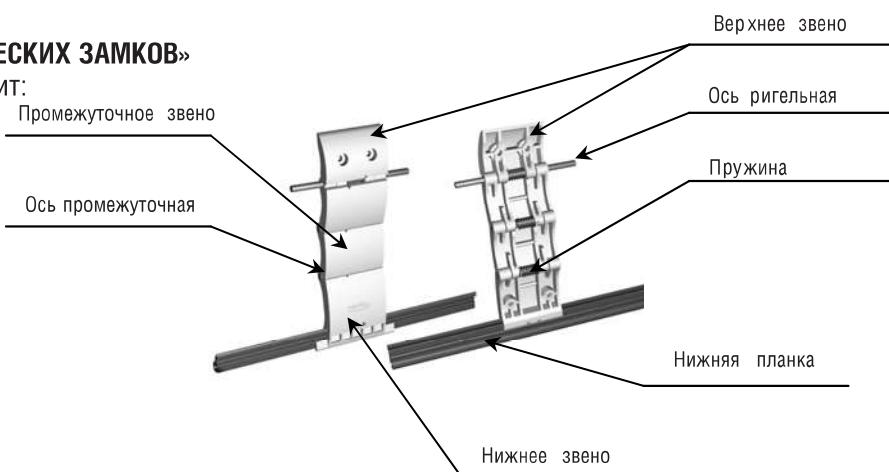
В зависимости от типа нижней планки автоматические замки подразделяются на два типа: RM и RB.
