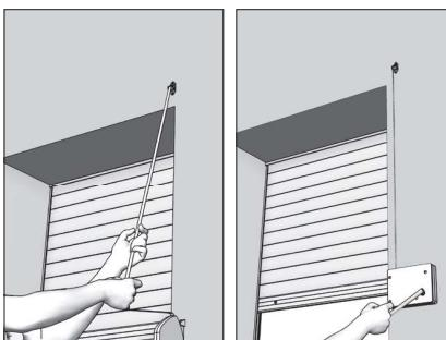
**Вариант монтажа роллеты с ленточным, шнуровым или кордовым приводом.**
