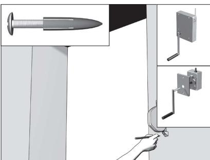
**Вариант монтажа роллете с ленточным, шнуровым или кордовым приводом.**
