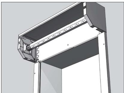
**Вариант монтажа роллеты с пружинно-инерционным механизмом.**
