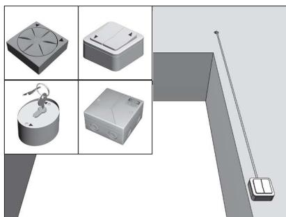
**Вариант монтажа роллете с электроприводом.**
