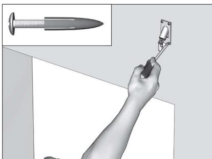
**Вариант монтажа роллеты с карданным приводом.**
