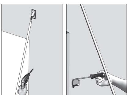
Наметьте и просверлите отверстия для крепления клипсы (при ее наличии в комплектации). Закрепите клипсу саморезами.
