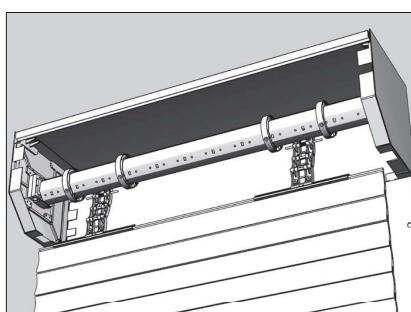
Свдите кольца до упора. Зафиксируйте положение колец саморезами. Вал сверлить запрещено! Саморез необходимо закручивать в радиальное отверстие ригельного кольца до упора в стенку вала. Не просверлите электропривод!
