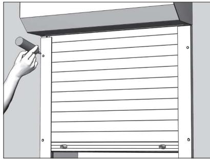
Произведите заделку монтажных зазоров при помощи герметика.
