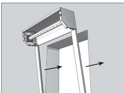
Установите каркас роллеты: приставьте каркас роллеты к проему при накладном монтаже; вставьте каркас в проем при встроенном монтаже.
