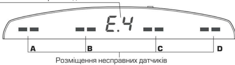
При увімкненні задньої передачі, система проведе самодіагностику і перевірить працездатність датчиків.
