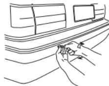
Накерните место установки датчика, чтобы избежать соскальзываания сверла.
