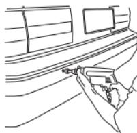
Электрической дрелью просверлите отверстие
