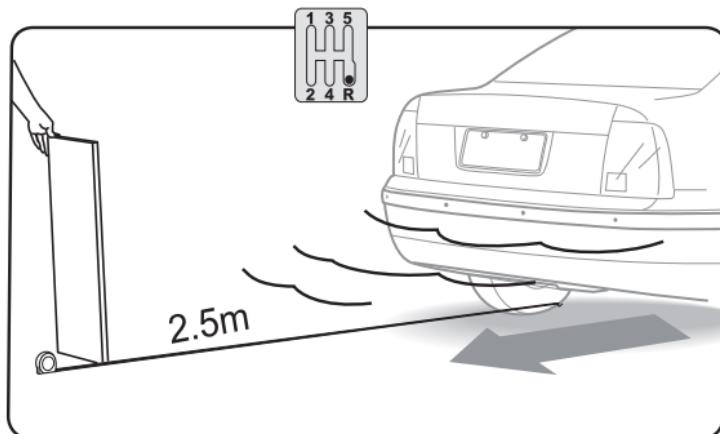
Проведите функциональный тест, используя деревянную доску (0.3м x 1м), установленную за автомобилем. Медленно сдавая назад, проверьте работоспособность каждой функции, указанной в данном руководстве.
