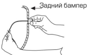
Надежно закрепите датчик в сделанном отверстии
