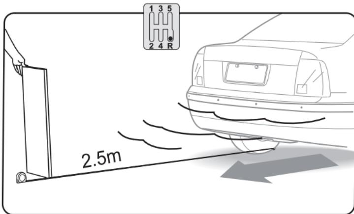
Проведіть функціональний тест, використовуючи дерев'яну дошку ( $0,3\text{м} \times 1\text{м}$ ), встановлену позаду автомобіля. Повільно сдаючи назад, перевірте працездатність кожної функції, яка вказана в цьому керівництві.
