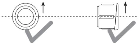
Некорректная установка датчика вызовет ложное срабатывание системы.
