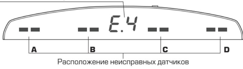
Расположение неисправных датчиков
