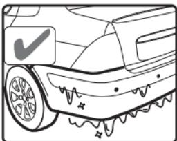
Если датчики покрыты льдом, растопите его теплой водой.
