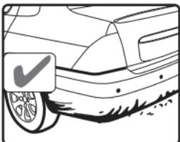
Если датчики покрыты грязью или снегом , очистите их, используя ткань или воду под слабым напором.
