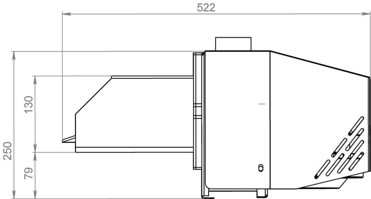
Рисунок 2 - Габаритные размеры горелки
