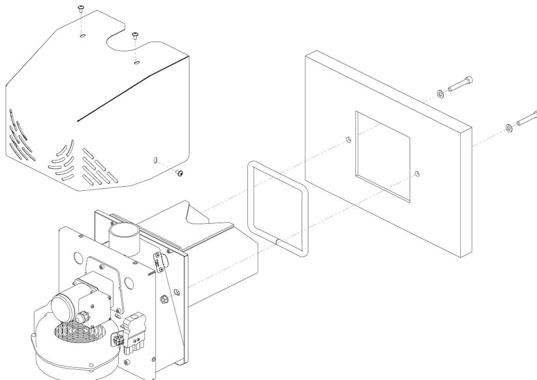
Рисунок 7 – установка горелки Air Pellet 15
