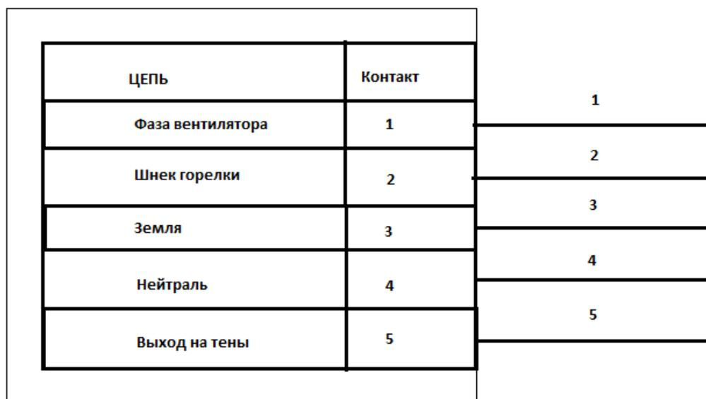
Рисунок 6 – Схема подключения к разъёму GST18I5
