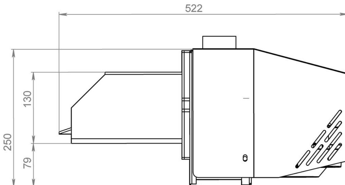
Рисунок 2 - Габаритные размеры горелки
