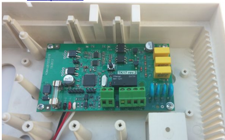
Рисунок 32. Установка коммуникатора «ТК-17»
