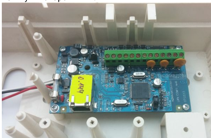
Рисунок 30. Коммуникатор «LanCom» rev.15 в корпусе прибора
