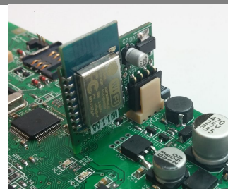
Рисунок 36. Установка модуля «W11M» в X6
