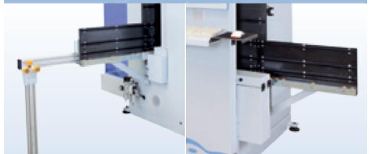
Mechanische Unterstützung mittels einer Röllchenbahn im Belege- und Entnahmebereich der Maschine.
