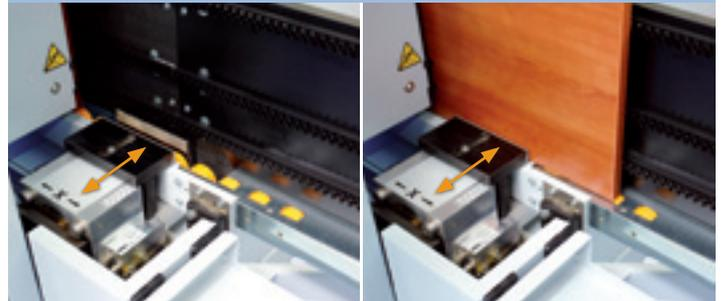
Einfaches Einstellen der Spannzange (manuell) auf Werkstückdicke (Spannzangenhub 10 mm). Bei Werkstückdickenunterschieden von bis zu 10 mm ist keine manuelle Einstellung der Spannzange notwendig.
