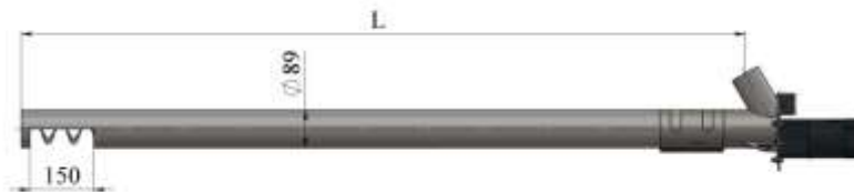
Рис.2 Геометрия комплектного шнека KVIТ Optima
