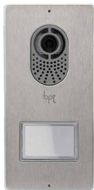
Видео вызывная панель LITHOS. Фронтальная панель из нержавеющей стали Широкоугольная цветная камера с высокой светочувствительностью для ночной съемки Светодиодная подсветка Подсветка клавиши колубого цвета Выход для прямого управления электрозамком Вход для внутренней кнопки открытия замка Возможность расширения клавиш вызова до 4х абонентов
