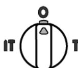
Положення **Vario-Lock** для регулювання положення робочого інструмента при довбанні
