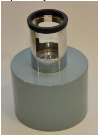
Рис. 2. Специализированная наковальня для молотка Шмидта
