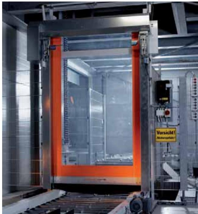
Качественное уплотнение полотна в направляющих дополнительно препятствует нежелательному обмену воздуха при перепадах давления. Стандартное полотно ворот полностью прозрачно и оснащено сигнальными полосами, по запросу возможна поставка цветного полотна по шкале RAL. Стойки и кожухи, выполняются из оцинкованной стали но могут быть исполнены из нержавеющей стали.
