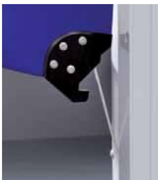
При столкновении мягкая нижняя кромка прогибается во все стороны. Натянутые тросы гарантируют ее контролируемое отклонение до того момента, пока не отщелкнутся фиксаторы между кромкой полотна ворот и направляющими. Полотно ворот выходит из боковых направляющих независимо от направления.
