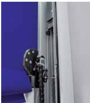
После удара работоспособность ворот восстановится автоматически: полотно ворот и его нижняя кромка будут отведены натяжными тросами обратно в боковые направляющие, после чего ворота должны быть опущены при помощи кнопки на блоке управления до конечного закрытого положения – именно тогда обратно защелкнутся фиксаторы полотна ворот в направляющих и ворота будут полностью готовы к их дальнейшей эксплуатации.
