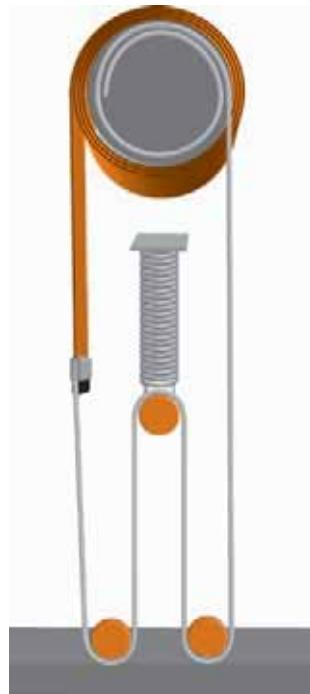
Система ветровой устойчивости компании EFAFLEX обеспечивает постоянное натяжение полотна ворот. Всегда на страже там, где ветер или разница давлений являются причиной сквозняка!
