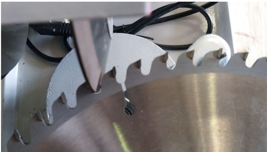
Мал. 2 Регулювання кроку заточення пильного диска
