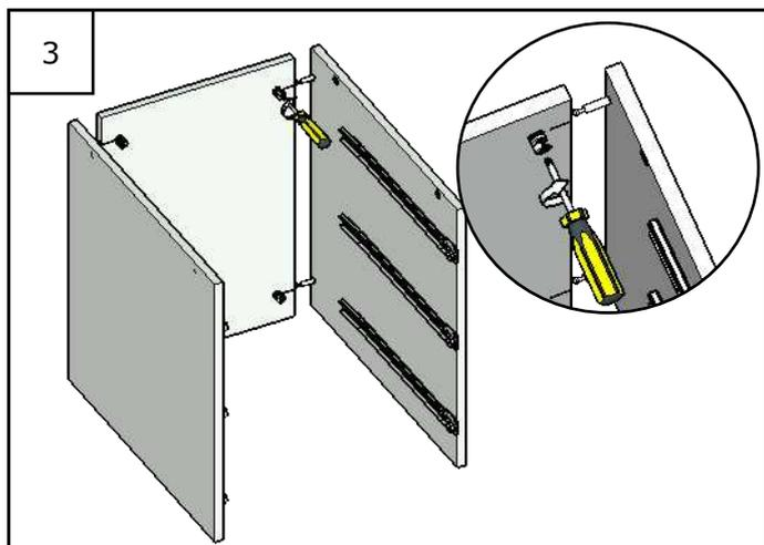
3 Вставляем эксцентрики минификса в заднюю стенку тумбы, а штоки в боковины тумбы. Скрепляем между собой.
