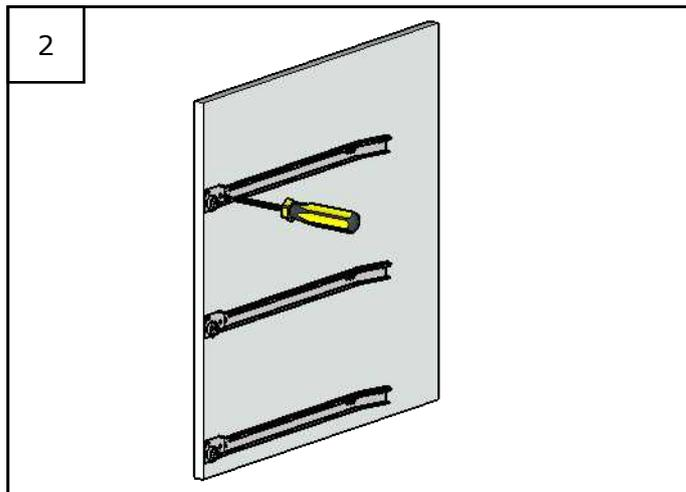
2 Саморезами прикручиваем направляющие к боковинам тумбы. И устанавливаем ножки.
