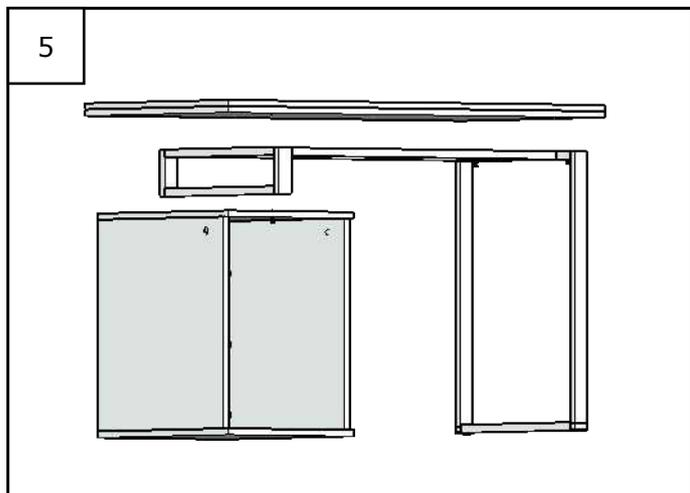
5 Винтами 6x30 крепим каркас к тумбе, а затем винтами прикрепляем столешницу.
