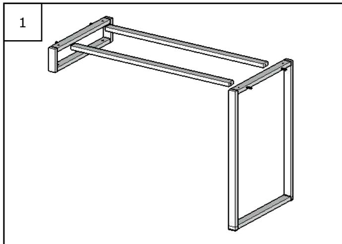
1 Ставим между стоевыми перемычки. Крепим их с помощью винтов 6x50.
