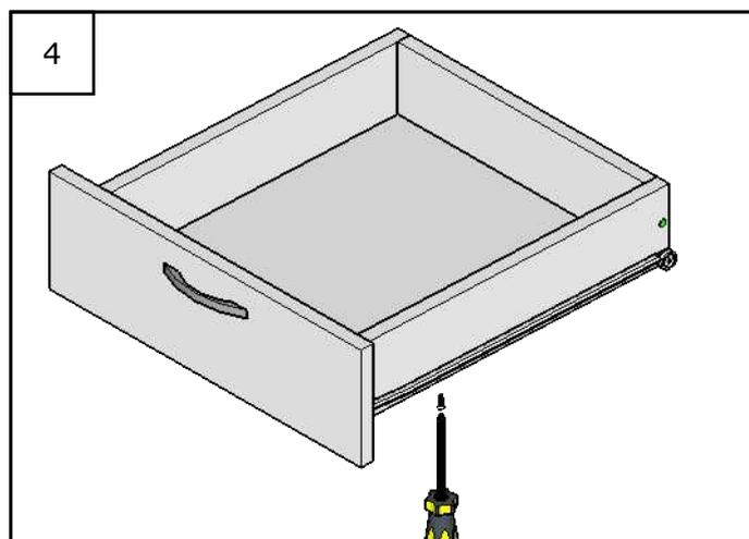
Прикручиваем внутреннюю часть направляющих к боковым деталям ящика саморезами
