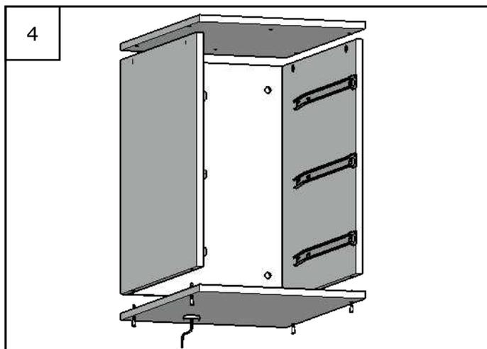
4 Затем крепим конфирматами дно к стоевым тумбы. И крышку прикручиваем с помощью минификсов.
