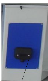
Разъём подключения кабеля от электросети
