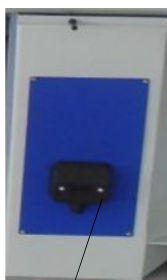
Роз'єм для приєднання кабелю електромережі
