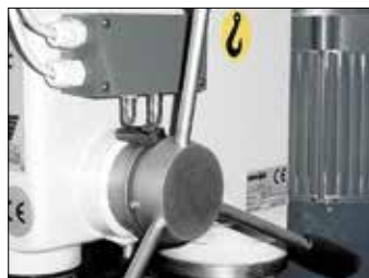
Код 18080: Нарезание резьбы с электронным управлением реверсом
