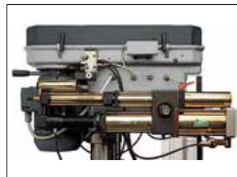
Код 30019: Гидропневматическая подача. Автоматический ход шпинделя 90/105 мм с быстрым возвратом на заданную глубину. Подача 5±2.500 мм/мин Сила толкания при 6 бар: 400 кг
