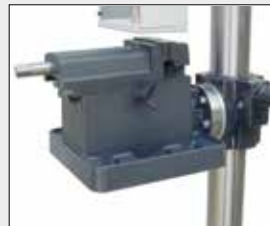
PGM: 325 x 325 мм Поворотный стол с зажимом
