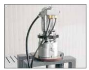
**Код 40097:** Пневматическое расцепление инструмента ISO
