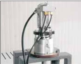
**Код 40097:** Пневматическое расцепление инструмента ISO 40.
