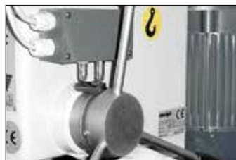
Code 18080: Нарезание резьбы с электронным управлением реверсом
