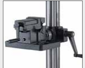
PGM: 350 x 250 мм Поворотный стол с зажимом
