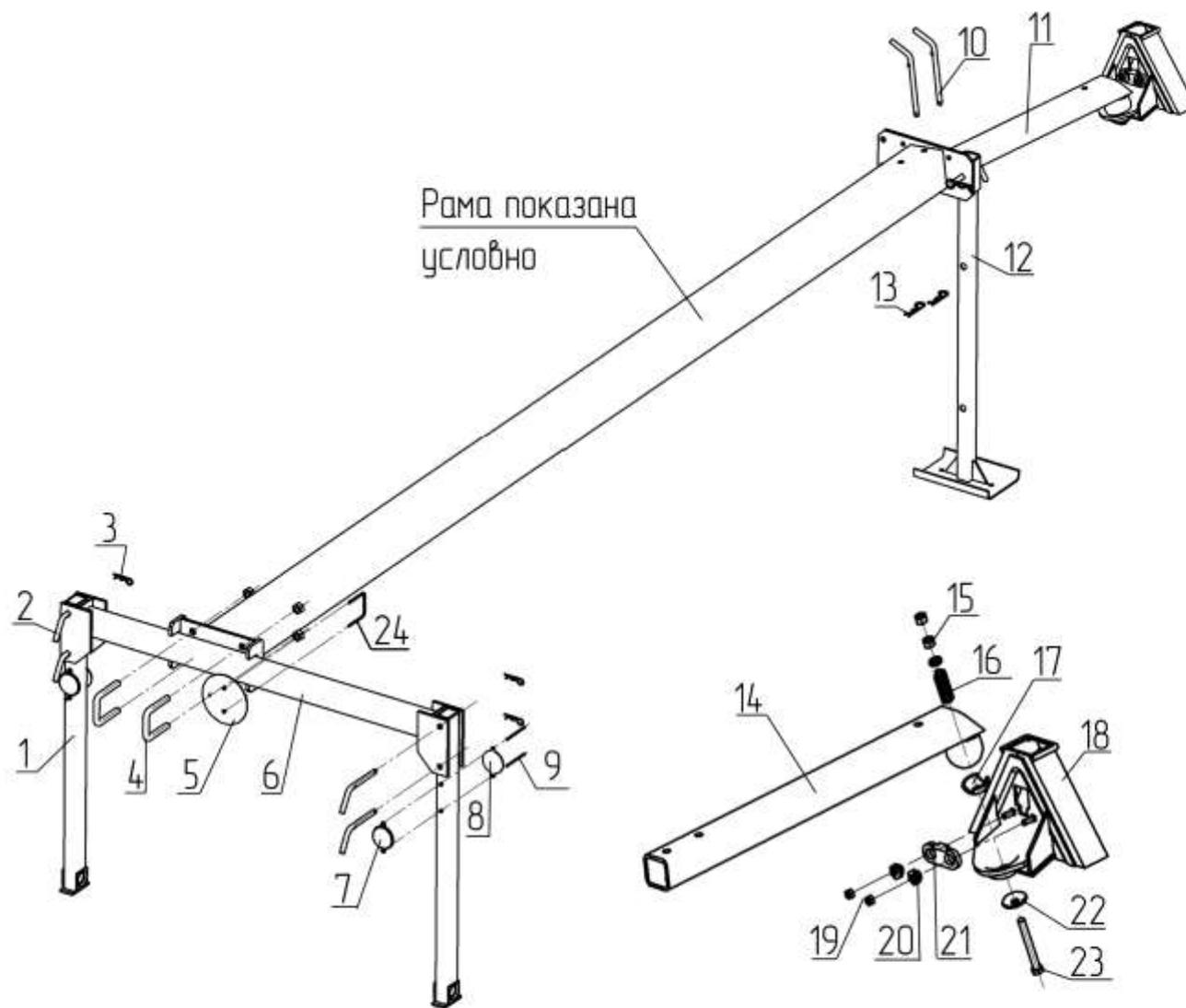
**Рис.6– Транспортное устройство КРН 46.150**
