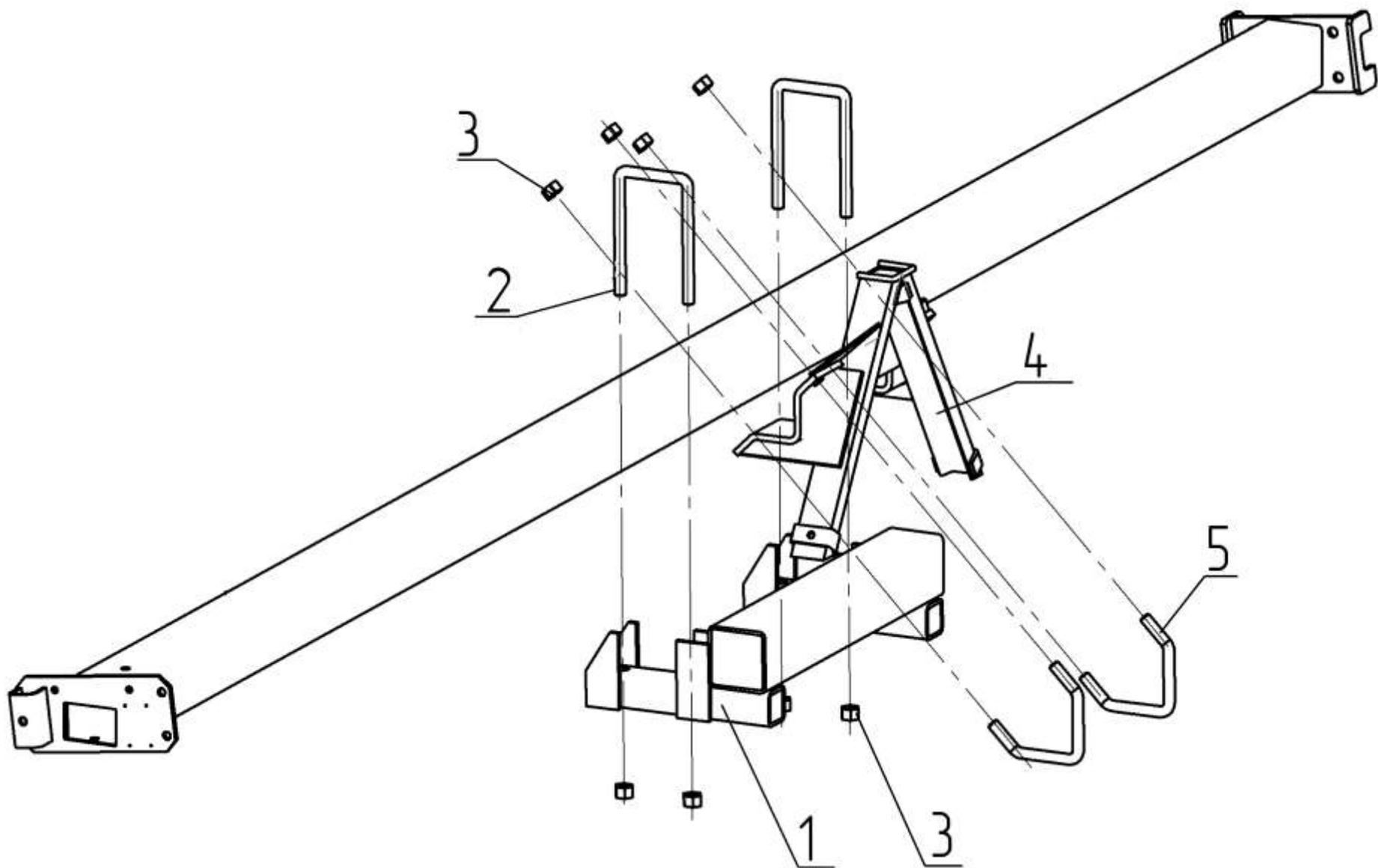
**Рис.10– Установка приспособления КРН 46.640 для смещения замка навески
