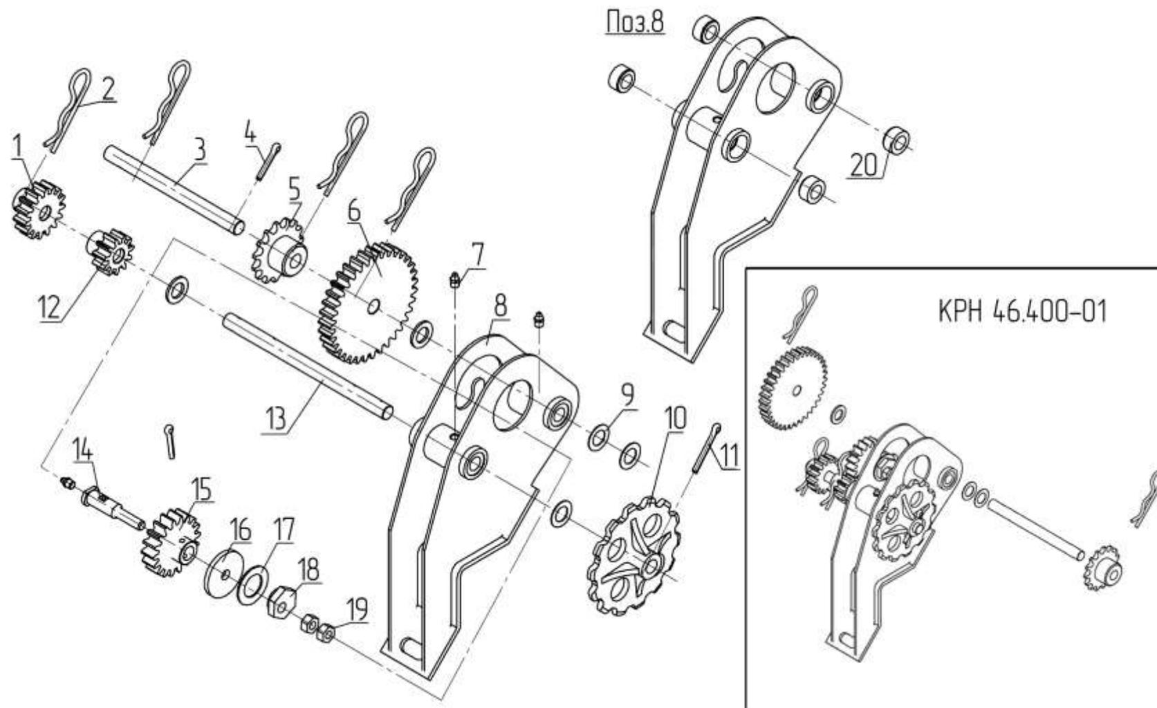
**Рис.9 – Механизм передач КРН 46.400 (правый)
