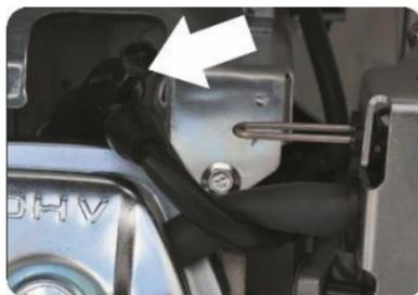
Свеча зажигания: эквивалент TORCH F6TC.
