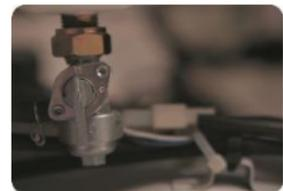
г) Закройте топливный краник - OFF (закрыто).
