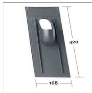
KE 0219 Universalbiber mit Auflage, Abmaße außen 29 x 60 cm u. innen 17 x 42 cm, Rahmenauflage 6 cm je Seite bis Aufkantung
