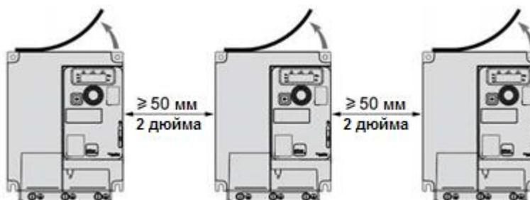
Свободное пространство  $\geq 50$  мм (2 дюйма) с каждой стороны. Вентиляционная крышка должна быть снята для работы преобразователя при температуре окружающего воздуха свыше 50 °C (122 °F). Степень защиты становится IP20.
