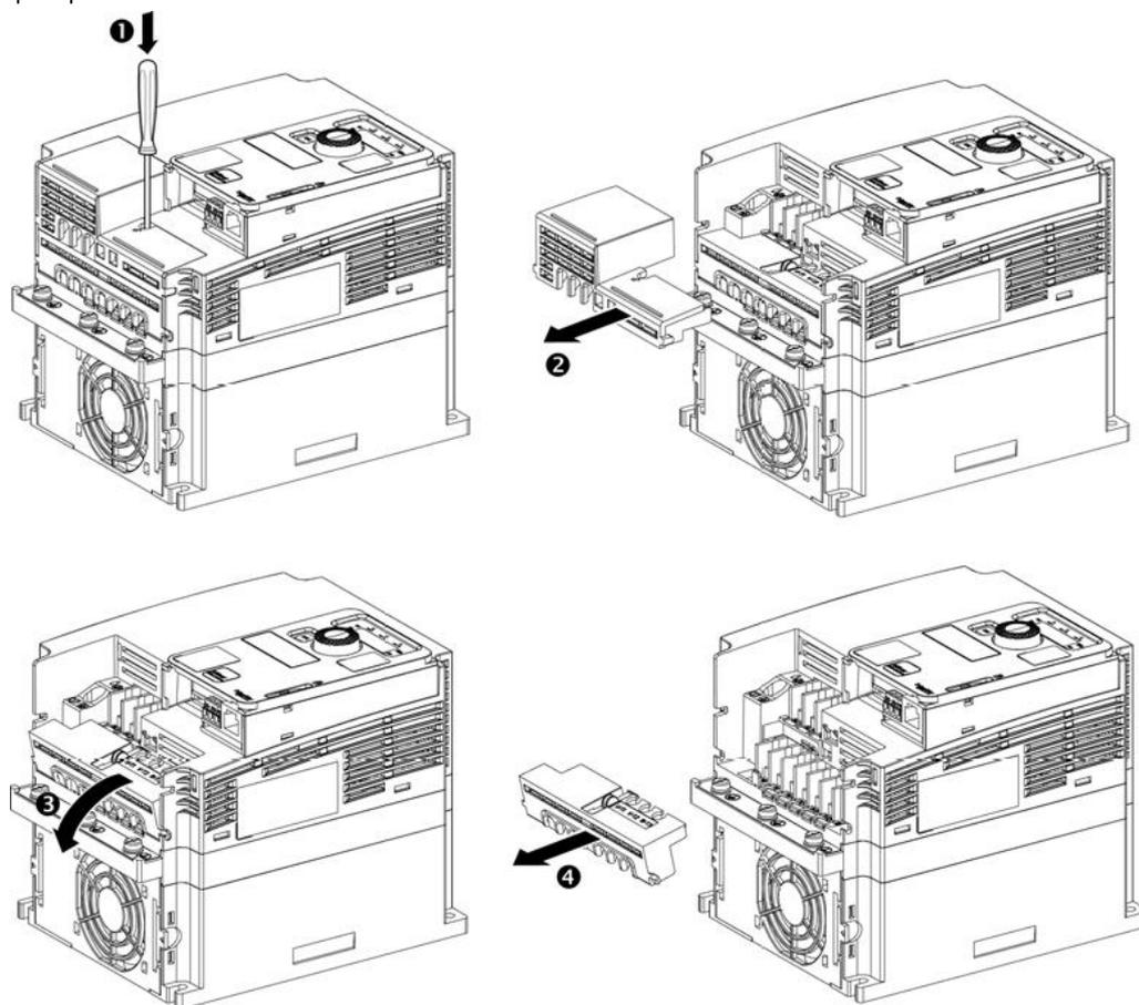
Применяйте следующие правила, чтобы получить доступ к силовым клеммам на преобразователях **типоразмеров 3С**
