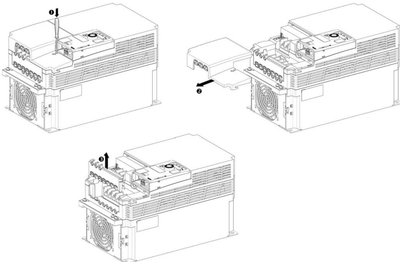
Применяйте следующие правила, чтобы получить доступ к силовым клеммам на преобразователях **типоразмеров 5C**
