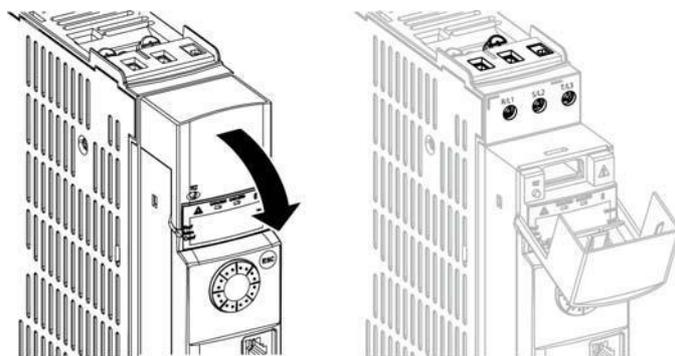
Применяйте следующие правила, чтобы получить доступ к силовым клеммам на преобразователях **типоразмеров 1В и 2В**
