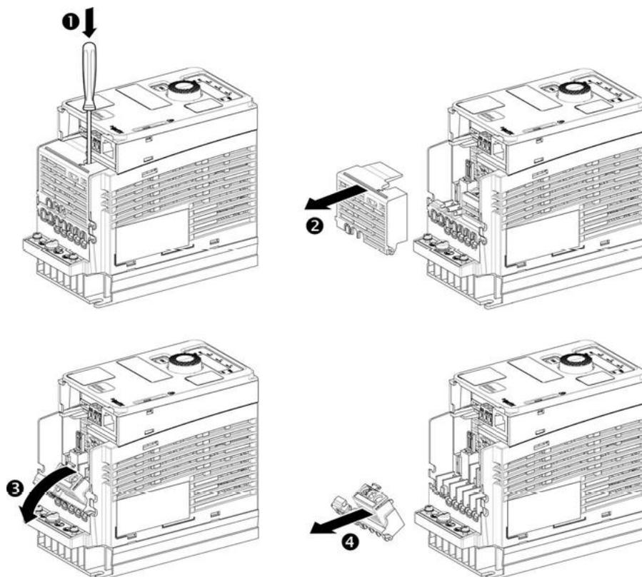
Применяйте следующие правила, чтобы получить доступ к силовым клеммам на преобразователях **типоразмеров 1С**
