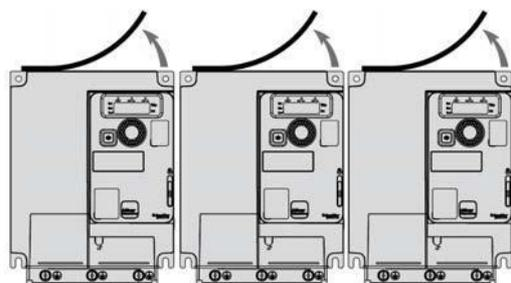
В преобразователях, смонтированных бок о бок, вентиляционная крышка должна быть снята. Степень защиты становится IP20.
