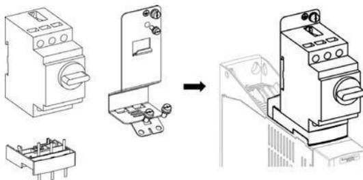
**ПРИМЕЧАНИЕ:** Габаритные размеры изделия, включающего смонтированные GV2, соединительную и ЭМС платы, становятся 424 мм (16.7 дюйм.)
