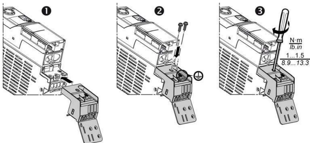
Выполните следующие указания для установки штепсельного соединителя
