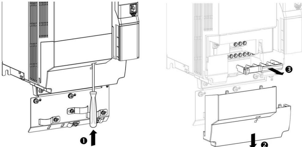
Применяйте следующие правила, чтобы получить доступ к силовым клеммам на преобразователях **типоразмеров 4В and 5В**
