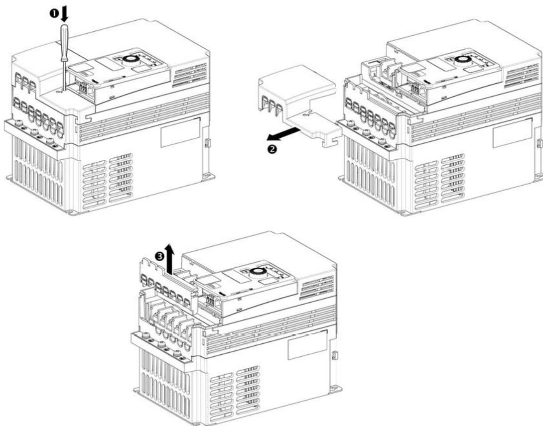
Применяйте следующие правила, чтобы получить доступ к силовым клеммам на преобразователях **типоразмеров 4С**
