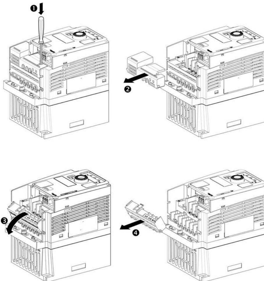
Применяйте следующие правила, чтобы получить доступ к силовым клеммам на преобразователях **типоразмеров 2С**
