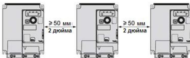
Свободное пространство  $\geq 50$  мм (2 дюйма) с каждой стороны, с установленной вентиляционной крышкой. Монтаж типа А подходит для работы преобразователя при температуре окружающего воздуха меньше или равной 50 °C (122 °F)
