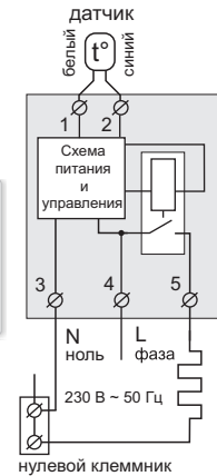
Схема 1. Упрощенная внутренняя схема и схема подключения
