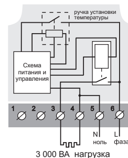
Схема 1. Схема подключения и упрощенная внутренняя схема
