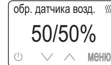
Возможная причина: произошел обрыв или короткое замыкание в цепи датчика, помехи от силовых проводов.
