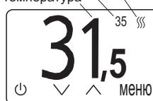
Нажмите и удерживайте левую кнопку в течение 5 с. После отключения терморегулятор перейдет в спящий режим. Для полного отключения выньте терморегулятор из розетки или отключите автоматический выключатель в щитке при длительном перерыве в использовании.
