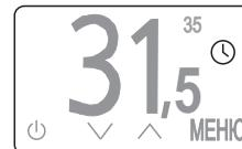
Иконка **ЧАСЫ** уведомляет о работе функции предварительного прогрева или ограничения частоты вкл. / откл. реле.
