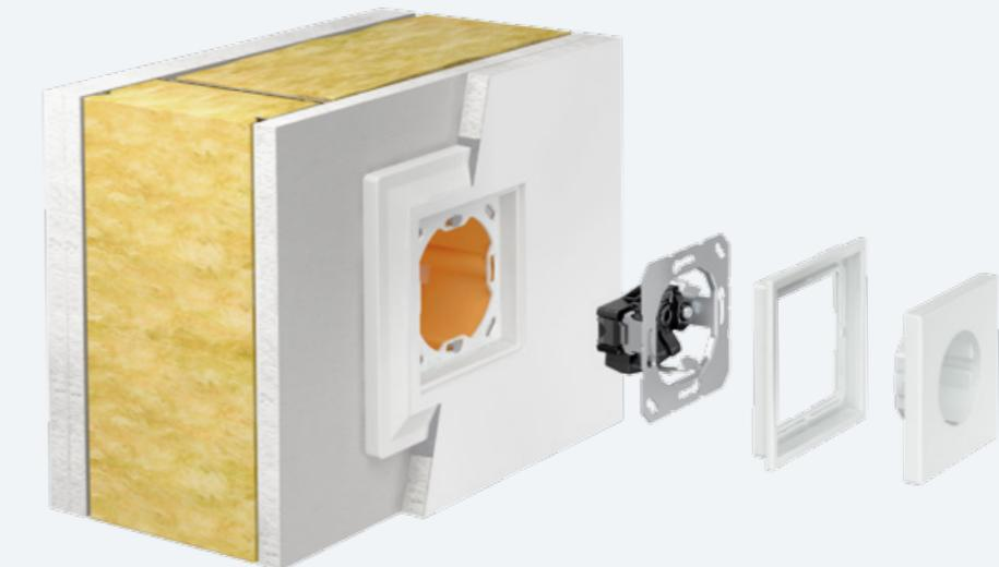
Главным требованием для установки является наличие 2 слоев гипсокартона. Монтажный адаптер имеет ту же толщину, что и лист гипсокартона (12,5 мм), что способствует установке изделия в один уровень со стеной.
