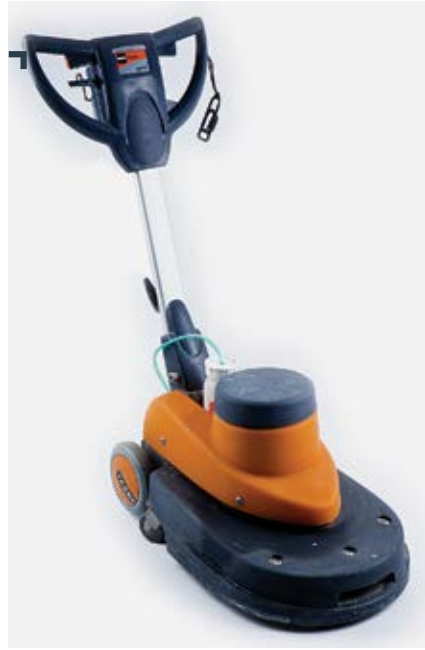
Шлифовальная машина Для шлифовки основания.
