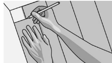
Рис. 109. Последний ряд досок перед укладкой необходимо тщательно измерить. Если он слишком широк, необходимо сузить доски до соответствующего размера. Обрезать доски нужно со стороны паза. После совмещения доски с остальными, дожать ее с помощью монтажного приспособления до устранения щелей.
