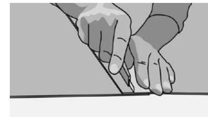
Рис. 38. Положить полотнища внахлест (3-5 см) и разрезать одновременно два полотнища по металлической планке.
