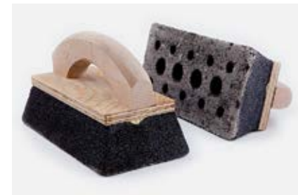
▮ Шлифовальный камень Для шлифовки основания на маленьких площадях и в углах.
