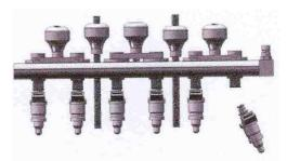
3. Тщательно зафиксируйте форсунки перед тестированием. Сначала проверьте сопротивление форсунок, если сопротивление больше  $1\Omega$  - форсунку необходимо заменить.
