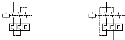
Рис. 4: Приєднання автоматичного вимикача захисту двигуна для захисту двигунів змінного або постійного струму (біметалеві розчіплювачі включені послідовно)
