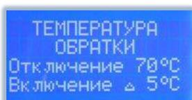
Рис. 8. Настройка температуры «обратки» теплоносителя
