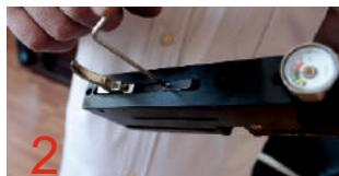
ВЫ МОЖЕТЕ ОТРЕГУЛИРОВАТЬ ДЛИНУ ХОДА СПУСКОВОГО КРЮЧКА БЕЗ РАЗБОРКИ РУЖЬЯ ЧЕРЕЗ ПРЕДОХРАНИТЕЛЬНУЮ СКОБУ СПУСКОВОГО КРЮЧКА (см.рис.1) И ОТРЕГУЛИРОВАТЬ УСИЛИЕ НАЖАТИЯ НА СПУСКОВОЙ КРЮЧОК.
