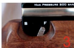
ПОЛОЖЕНИЕ ПРЕДОХРАНИТЕЛЯ В ПОЗИЦИИ "F" ОЗНАЧАЕТ ГОТОВНОСТЬ К СТРЕЛЬБЕ (см.рис.3). ПОЛОЖЕНИЕ ПРЕДОХРАНИТЕЛЯ В ПОЗИЦИИ "S" ОЗНАЧАЕТ НЕВОЗМОЖНОСТЬ СТРЕЛЬБЫ (см.рис.4)
