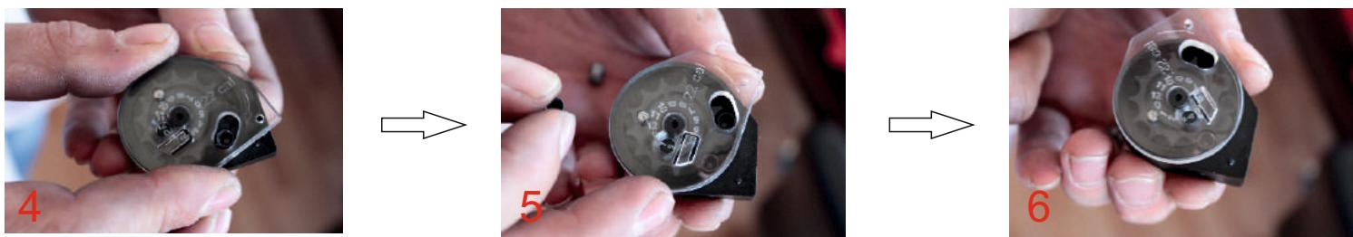
КОГДА ОКНО ЗАРЯДКИ В КРЫШКЕ ДОСТИГНЕТ ПОСЛЕДНЕЙ ПОЗИЦИИ, НЕ ПРОИЗВОДИТЕ ТОЛКАЮЩЕ УСИЛИЕ НА ПРУЖИНУ. КРУТИТЕ КРЫШКУ В ОБРАТНОМ НАПРАВЛЕНИИ И ВСТАВЛЯЙТЕ ПУЛИ. **ВНИМАНИЕ:** НЕ ПРИМЕНЯЙТЕ УСИЛИЕ, ЭТО МОЖЕТ ПРИВЕСТИ К ПОЛОМКЕ КОНСТРУКЦИИ.
