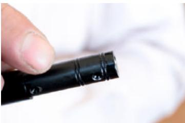
СТВОЛ ИМЕЕТ 3 УПЛОТНИТЕЛЬНЫХ КОЛЬЦА, ДВА ИЗ НИХ РАСПОЛОЖЕНЫ СНАРУЖИ И ОДИН ВНУТРИ. В СЛУЧАЕ ДЕФОРМАЦИИ, ПОЖАЛАУЙСТА, ЗАМЕНИТЕ ИХ ЗАПАСНЫМИ УПЛОТНИТЕЛЬНЫМИ КОЛЬЦАМИ, КОТОРЫЕ НАХОДЯТСЯ В КАЧЕСТВЕ ЗИПА ВАШЕЙ ВИНТОВКИ.
