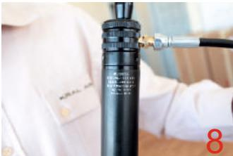
ЗАПРАВОЧНЫЙ ВЫХОД РАСПОЛОЖЕН В ВЕРХНЕЙ ЧАСТИ БАЛЛОНА (см.рис. 8). ПОДСОЕДИНИТЕ ШЛАНГ НАСОСА К ПЕРЕХОДНИКУ ДЛЯ ЗАРЯДКИ БАЛЛОНА. ПЕРЕХОДНИК ИДЕТ В КОМПЛЕКТЕ С ВАШЕЙ ВИНТОВКОЙ. ЕСЛИ ВЫ СЛЫШИТЕ ТРАВЛЕНИЕ ВО ВРЕМЯ ПЕРВОЙ НАКАЧКИ, ПОДТЯНите ПЕРЕХОДНИК. (ЕСЛИ УТЕЧКА БУДЕТ ПРОДОЛЖАТЬСЯ, УПЛОТНИТЕЛЬНОЕ КОЛЬЦО МОЖЕТ БЫТЬ ДЕФОРМИРОВАНО, ЗАМЕНИТЕ ЕГО)
