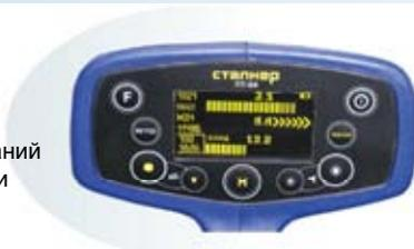
Точное определение мест повреждения изоляции совместно с локализацией оси коммуникации.
